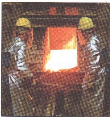
Beim Guss entweicht Luft aus der Form als Stichflamme
